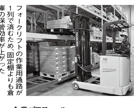
フォークリフトの作業用通路が1列で済むため、固定棚よりも倉庫の保管効率が上がった
